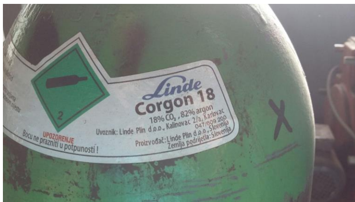
Slika 4.7 Primjer plinske mješavine za MAG postupak
